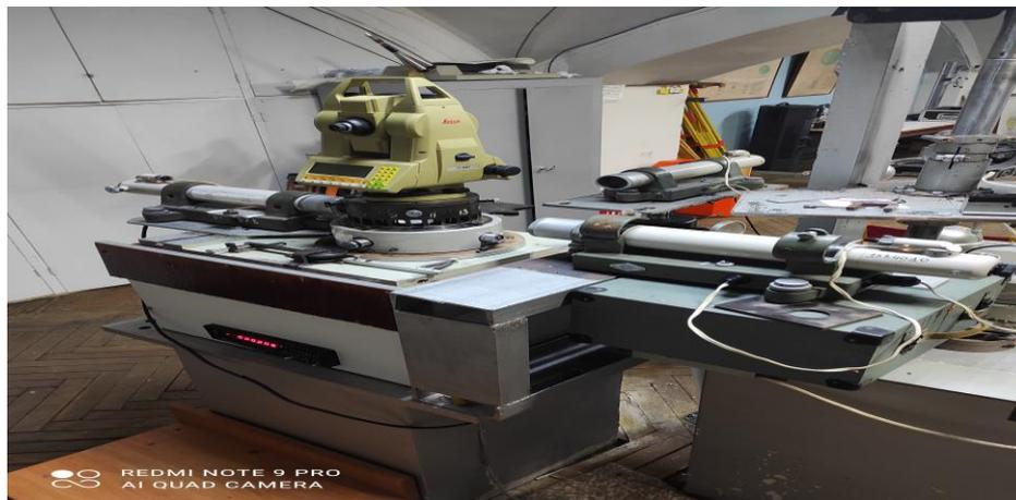
**Рисунок 13 – Механическая реализация горизонтального углового компаратора: 1 – исследуемое МКСИ, 1 – автоколлиматор, ориентированный на первую грань призмы, 2 – автоколлиматор, установленный под  $90^\circ$ , автоколлиматор, установленный через  $180^\circ$ , 4 – цифровой блок преобразователя ROD-800, 5 – поворотный стол ватель ROD-800 фирмы «Хайден Хайн (германия).**
