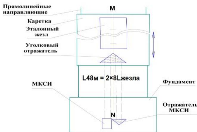
позволяет, зная температуру жезлов и их коэффициенты линейного расширения, исключить рефракцию из результатов измерений и определить длину волны источника излучения МКСИ. Схема показана на рисунке 4.
