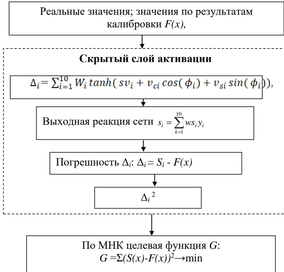
**Рисунок 6 – Блок – схема нейронной сети**
